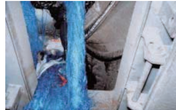
細かく裁断されずに出された網やシートが機械にまきつき、作業が停止しています。
