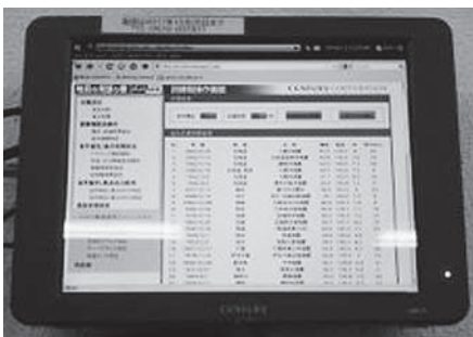
緊急地震速報装置
