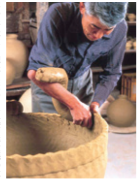
平安時代より現代に伝わる、越前焼大甕の成形技法。
