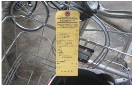
▲不良箇所を示す黄色いタグ
